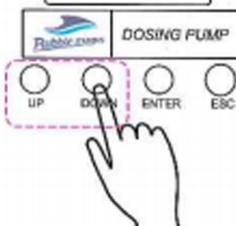
Pressione UP/DOWN para escolher a quantidade de aditivo, pressione ENTER para ir para o próximo número, pressione ENTER quando o último número for selecionado para ir para o próximo passo.
