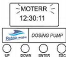
Quando o motor estiver funcionando e falhar, aparecerá na tela a mensagem "MOTERR" e o horário que ocorreu a falha. O dispositivo deve parar e funcionar e apitar um alarme até desligar.
