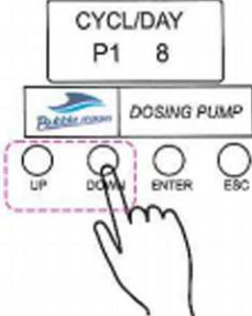
Pressione UP/DOWN para adicionar os ciclos, pressione ENTER para confirmar e ir para o próximo passo.
