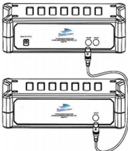
Use o conector do T12, na conexão de entrada atrás do T12 e o outro na conexão GROUP B (PUMP4-7) ou GROUP C (PUMP8-11) atrás do T11. Configure cada bomba no T11.
